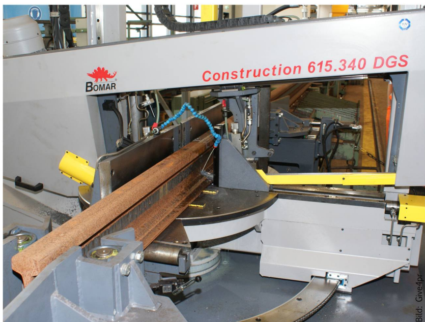
Der absenkbare Säge-tisch der Anlage macht es möglich, dass in der Schweißstraße befindliche Schienen, die nicht gesägt werden sollen, über Rollenbahnen das System einfach durchlaufen.
