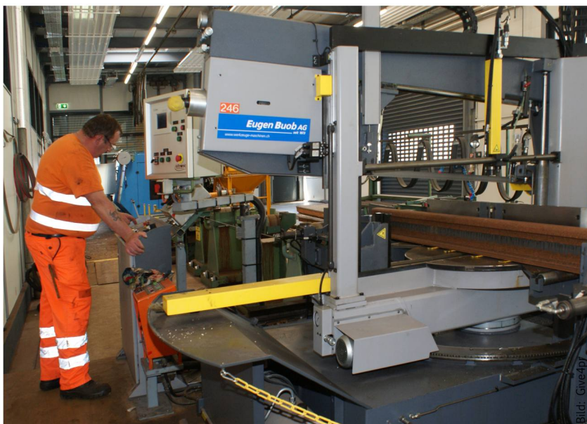
An der Bomar-Säge dient eine intuitiv bedienbare Nutzeroberfläche mit Dialogsystem und großem Display einer schnellen, übersichtlichen sowie eindeutigen Kommunikation mit dem System.
