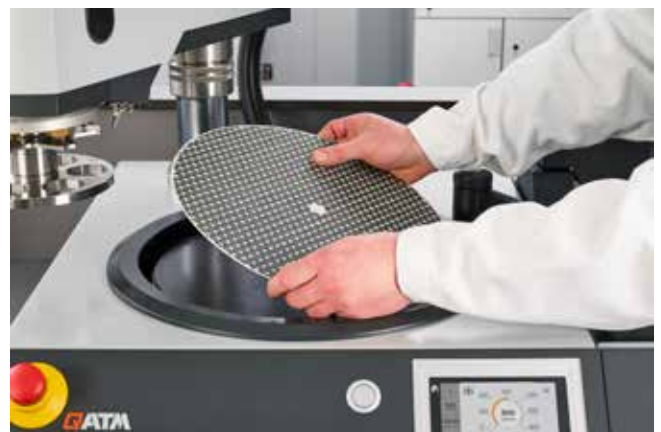
Platzieren von z.B. einer Diamantschleifscheibe auf der Magnetfolie
