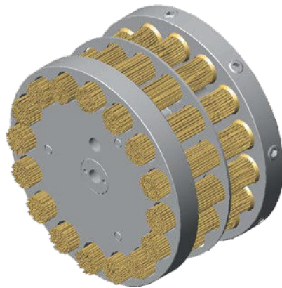
Schematische Darstellung eines Bürstkopfes für Entgratpinsel
