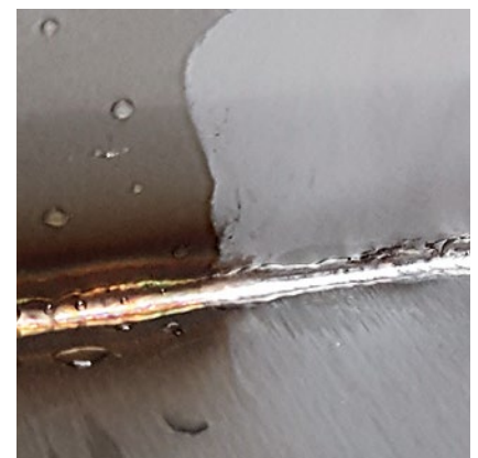
vor der Bearbeitung | nach der Bearbeitung Reinigung von Schweißnähten
