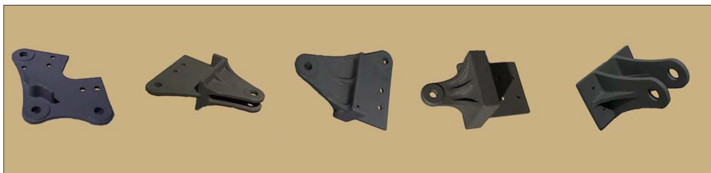
Bild 4: Die fünf Stahlgussknoten-Gussteile für die freitragende Dachkonstruktion aus G20Mn5N im Massebereich von 7 bis 23 kg
