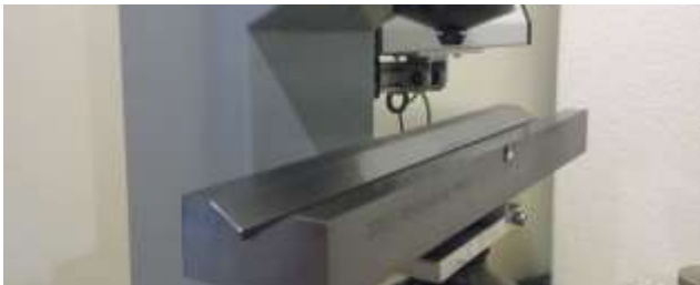
Prüftisch prismatisch max. Ø 50mm, 400mm lang
