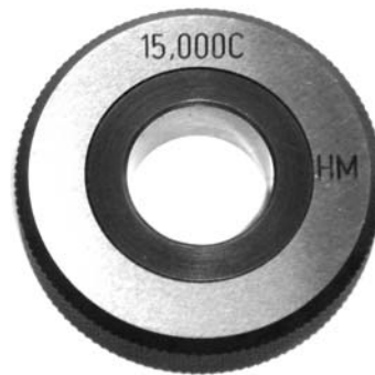
Hartmetall (eingesetzter Hartmetallring) Carbure métallique (emmanché)
