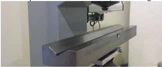
Prüftisch prismatisch max. \varnothing 50mm, 400mm lang
